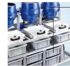
Система хранения дополнительных пластиковых контейнеров для абразивов
