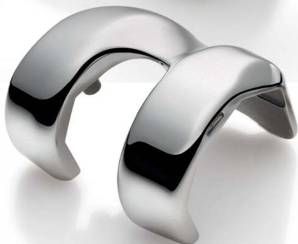
После (кромки закруглены, царапины отсутствуют, высокий блеск поверхности, показатель Ra < 0.01 мкм)
