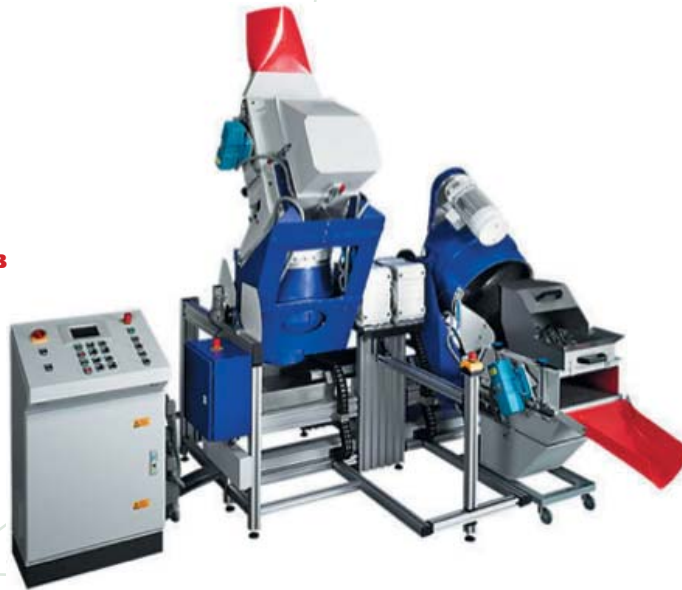
Галтовка роторная OTEC CF 2x50 MR с вибрационной системой просеивания (автомат)
