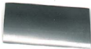
Обработанные детали. Титан, сталь. Толщина 0,15-0,25 мм.
