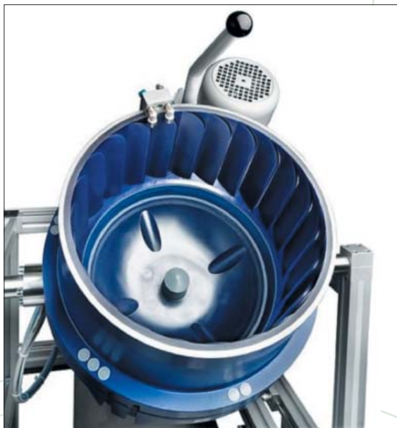
CF 1x18 Element (модель с одним рабочим контейнером объемом 18 л). Возможно расширение от 1 до 6 рабочих контейнеров.
