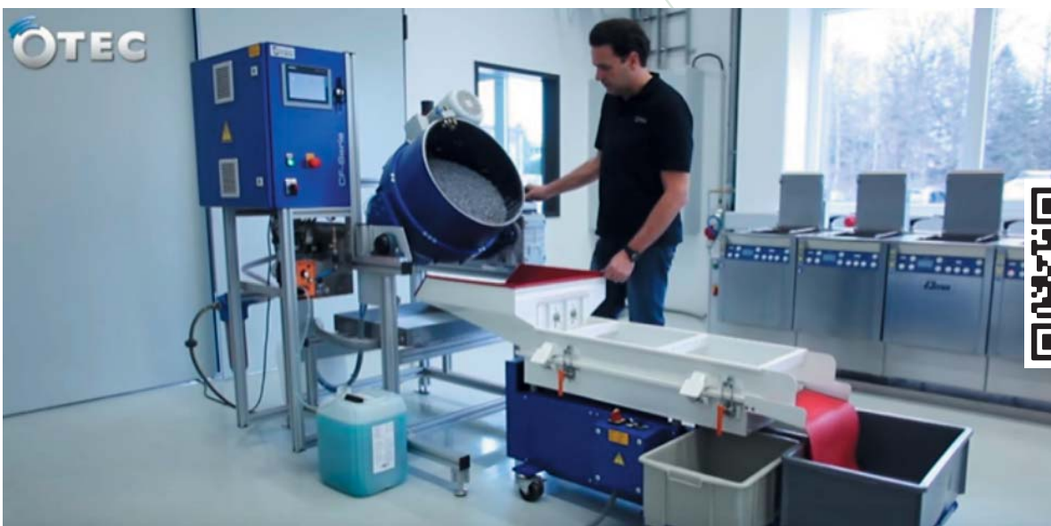
Специальная разработка OTEC – система вибрационной сепарации UNISEPA (полуавтомат, передвижная, на колесиках) совместима со всеми машинами серии CF
