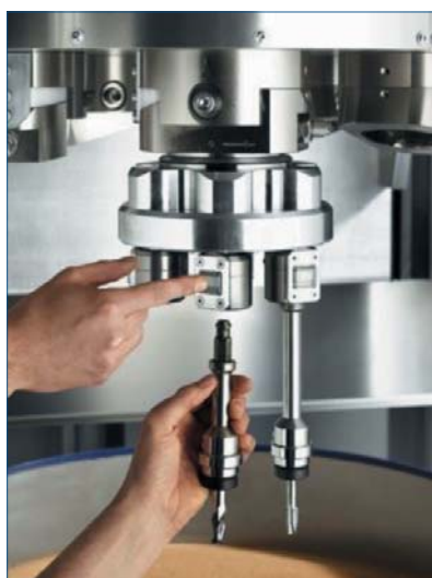
Рис. 5: Замена обрабатываемой заготовки в независимо вращающемся держателе
