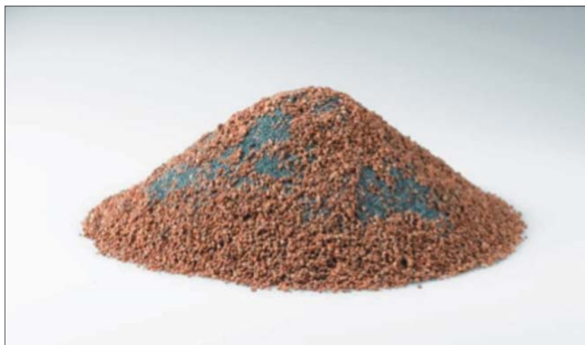
Рис. 2: Гранулы HSC 1/300 для сверхчистовой обработки от компании ОТЕС
