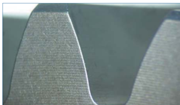
Рис. 17: Боковые поверхности зубьев после чистовой обработки
