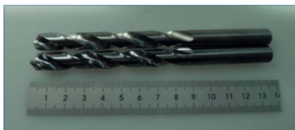
Рис. 3: Сверло до и после чистовой обработки
