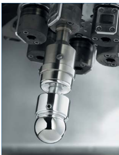
Рис. 6: Держатель устанавливается под углом; каждая обрабатываемая заготовка вращается независимо.
