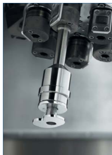
Рис. 7: Угловой, независимо вращающийся, держатель обрабатываемой заготовки (имплант большой берцовой кости)
