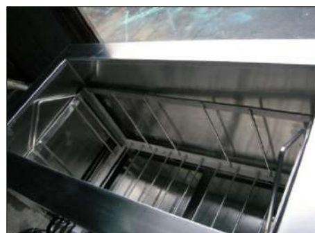
Ванна с двумя погружными ультразвуковыми плитами и установленной стальной корзиной
