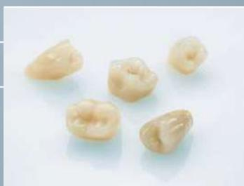
Мелкие керамические или пластиковые изделия, такие как зубные имплантаты. Здесь особенно важно, чтобы удаление заусенцев, сглаживание и полировка выполнялись без заметного закругления кромок.
