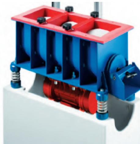
При необходимости контейнер можно разделить на три меньших по размерам камеры – для одновременной раздельной обработки изделий.
