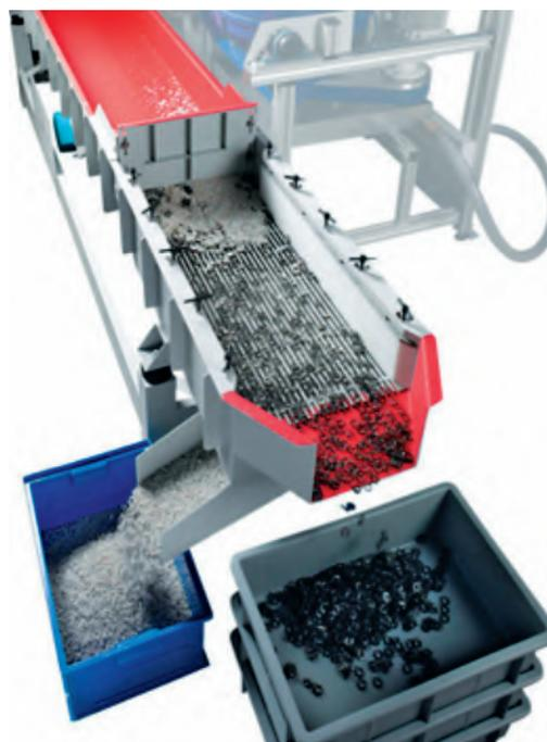
Содержимое барабана при его опрокидывании попадает на лоток или в бункер, откуда подается для просева на виброконвейере
