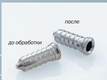
На винтовых имплантатах удалены заусенцы, они отшлифованы и отполированы до блеска всего за один цикл обработки на машине OTEC CF, причем острые кромки сохранены.
