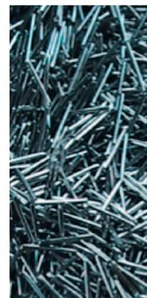
Удаление металлической стружки и заусенцев происходит даже в самых труднодоступных углах изделий, в шлицах, пазах и в сверленных (фрезерованных) отверстиях малого диаметра: тонким иголкам это вполне под силу. В числе других результатов – разглаживание и упрочнение поверхности.
