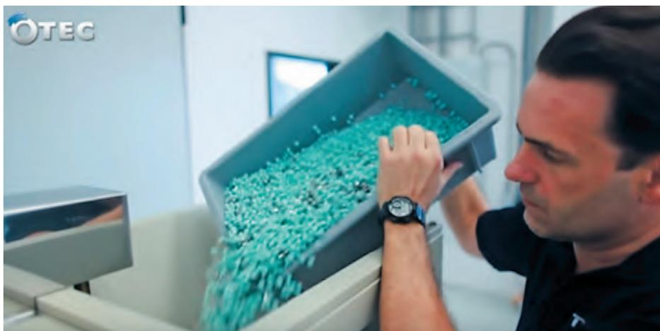
Встроенная насосная система обеспечивает регулируемый проток воды (снизу вверх) через прозрачный разделительный стакан, в который вбрасывается смесь «наполнитель + изделия».
