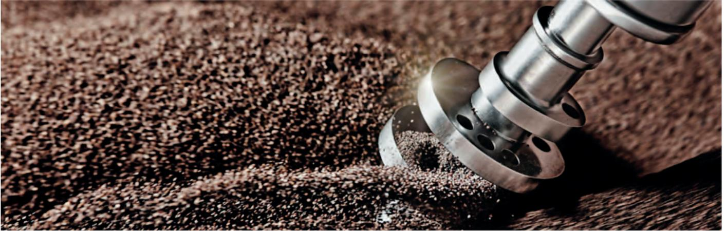
Пример обработки распредвала автомобильного двигателя. Задачи: удаление заусенцев, скругление кромок и сглаживание поверхности. Параметр шероховатости Ra до обработки 0,4 мкм.
