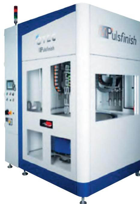
Продолжительность циклов обработки в машинах SF, оснащенных технологией Pulsfinish, как правило, составляет от 20-25 до 50-60 сек.
