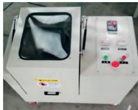
Детали, подлежащие обработке, вместе с полировальным абразивом засыпаются в барабан (при "мокрой" обработке в него также заливаются компаунд и вода). Барабан помещается в один из четырех поворотных стаканов и фиксируется специальным зажимным устройством.
