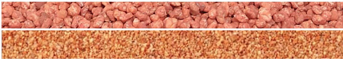
**Ореховый наполнитель предназначается для сухой финишной шлифовки и полировки изделий из цветных металлов, титана, стальных сплавов в галтовочных машинах любого типа.**
