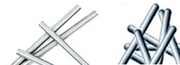
Использование иголок со скругленными концами в ряде случаев дает лучший полировальный эффект (особенно при высоком качестве отливок). Скругление концов (притупление острых краев) у иголок можно осуществить самостоятельно. Для этого в барабан магнитной машины засыпаются иголки и горсть абразивного пластикового наполнителя (например, КТ-10), либо керамического наполнителя. Машина включается, и эта смесь прокручивается в течение 30-40 мин.
